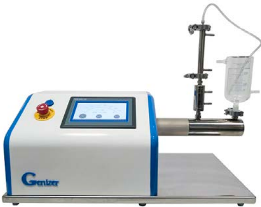
Einlassbehälter: Ummantelter Glaszylinder
